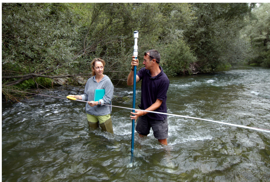
Figura 11. Rilevamento velocità dell'acqua
